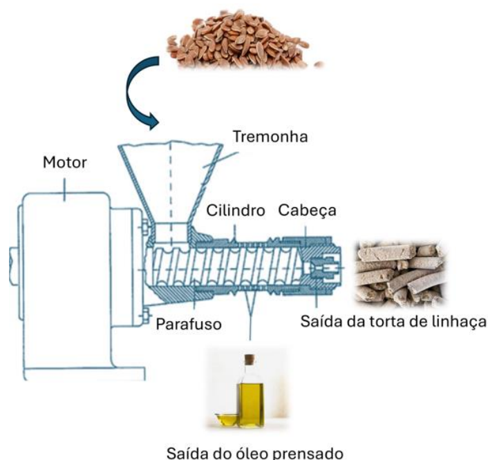
Figura 4 – Modelo de extrator de óleo baseado em prensagem de sementes a frio.
