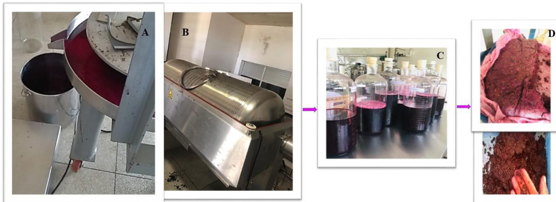
Figura 4 – Prensagem da uva. A: Prensa hidráulica; B: Prensa pneumática; C: Suco obtido do processo de prensagem; D: bagaço da uva.
