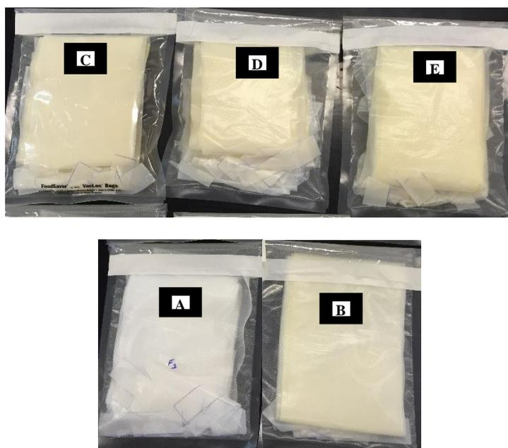
**Figura 1.** Filmes de PBAT produzidos por meio da técnica de extrusão, onde (A) OEO<sub>0,0</sub>; (B) OEO<sub>2,5</sub>; (C) OEO<sub>5,0</sub>; (D) OEO<sub>7,5</sub> e (E) OEO<sub>10,0</sub>.
